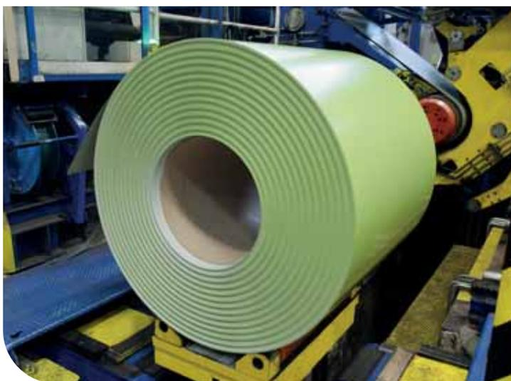
Lavoriamo alluminio, acciaio e lamiere zincate di alta qualità provenienti da rinomate fonderie europee sulla nostra linea di verniciatura in coil. Tutti i materiali vengono sottoposti a un'ispezione in entrata e la loro qualità è garantita dal certificato di ispezione del produttore.
