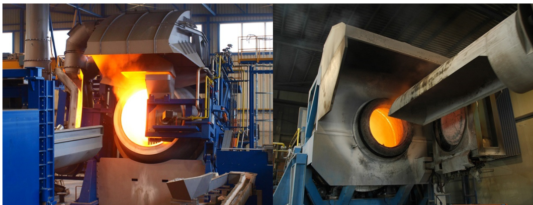
Obr.2 Rotační bubnové pece 16t a 12t s technologií tavení pod solnou struskou
