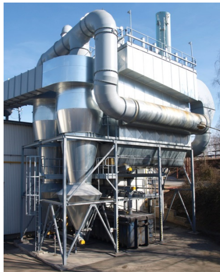
Obr.1 Filtrační jednotka s kapacitou 130 000 m 3 /h
